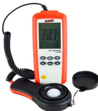
Figura 10 - Luxímetro ICEL LD-550 utilizado em campo.
